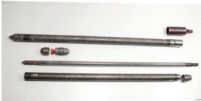
Figura 2 – Sonda específica para Cravação Contínua ( Direct Push ) modelo Power Probe 9100-ATV e ferramentas para amostragem de solo tipo Piston Sampler
