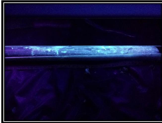
7. Nos *liners* que a lâmpada UV-A não indicava nenhuma anomalia, eram selecionadas alíquotas para nova checagem nos contatos litológicos, nas pontas e no centro do *liner*. Essa nova checagem era feita com a desagregação das partículas de solo e avaliação com a lâmpada UV-A nos saquinhos plásticos tipo Zip®. Em nenhum ponto ocorreu a detecção de óleo nas alíquotas dos saquinhos que não tenha ocorrido no *liner*.
